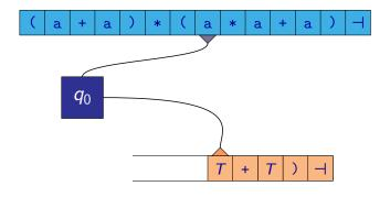
$$\cdots \Rightarrow (a+a)*(\underline{E}) \dashv \Rightarrow (a+a)*(\underline{E}+T) \dashv \Rightarrow (a+a)*(\underline{T}+T) \dashv$$
