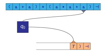
$$\cdots \Rightarrow (a+a)*(a*\underline{F}+T) \dashv \Rightarrow (a+a)*(a*a+\underline{T}) \dashv$$
