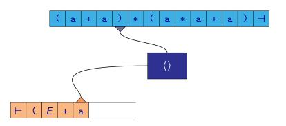
$$(\underline{\underline{E}}+a)*(a*a+a)\dashv \Rightarrow (\underline{\underline{T}}+a)*(a*a+a)\dashv \Rightarrow (\underline{\underline{F}}+a)*(a*a+a)\dashv \Rightarrow \dots$$
