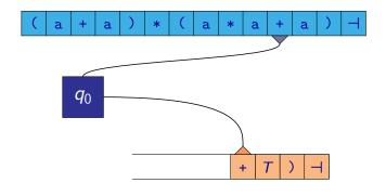
$$\cdots \Rightarrow (a+a)*(a*\underline{F}+T) \dashv \Rightarrow (a+a)*(a*a+\underline{T}) \dashv$$
