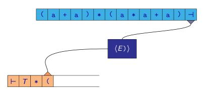
$$T*(\underline{E}) \dashv \Rightarrow T*(E+\underline{T}) \dashv \Rightarrow T*(E+\underline{F}) \dashv \Rightarrow T*(\underline{E}+a) \dashv \Rightarrow \cdots$$
